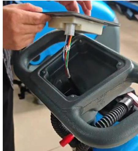
2. Verwenden Sie die entsprechenden Werkzeuge (M6 Schraubendreher), um die Schraube im Inneren gemäß der Abbildung rechts zu drehen. Denken Sie daran: Die Schraube muss nicht fest angezogen werden. Drehen Sie sie stattdessen hin und her, bis der Griff stabil sitzt.
