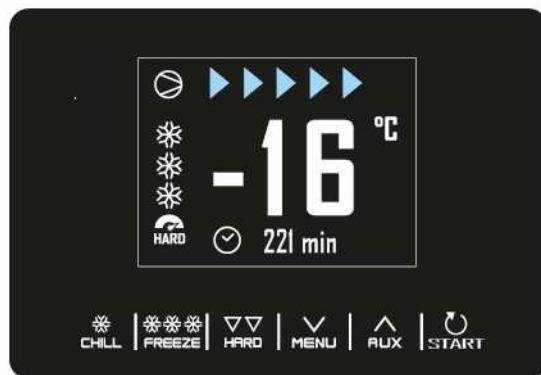
Wenn der Nadelfühler die richtige Temperatur erreicht hat oder die Zeitspanne abgelaufen ist, ertönt nach Beendigung des Schockkühl-/Schockgefrierzyklus der Summer und die Konservierungsphase beginnt. Wird der temperaturgesteuerte Zyklus nicht in der vorgesehenen Zeit abgeschlossen, wird das Problem durch eine Alarmsmeldung angezeigt.
