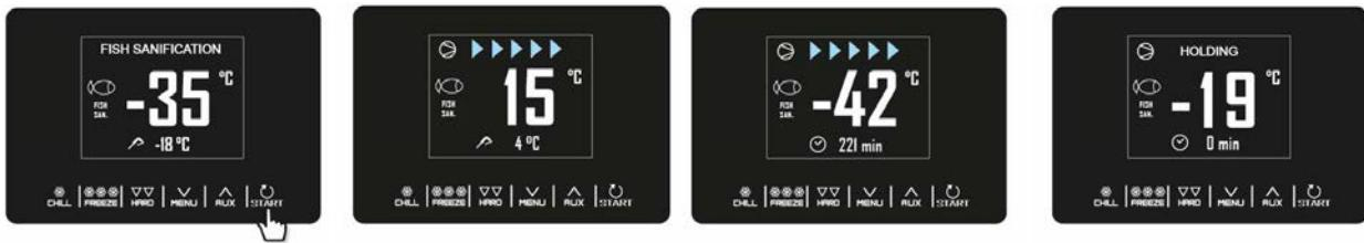
Während eines Sanierungszyklus zeigt das Gerät immer die Schranktemperatur und, je nach laufender Phase, die Endtemperatur der Schockkühlung oder die Dauer der Haltephase an.
