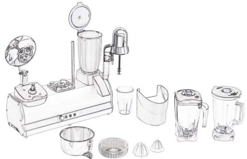
Abb. Nr. 13 – Zur Reinigung zerlegte Maschine
